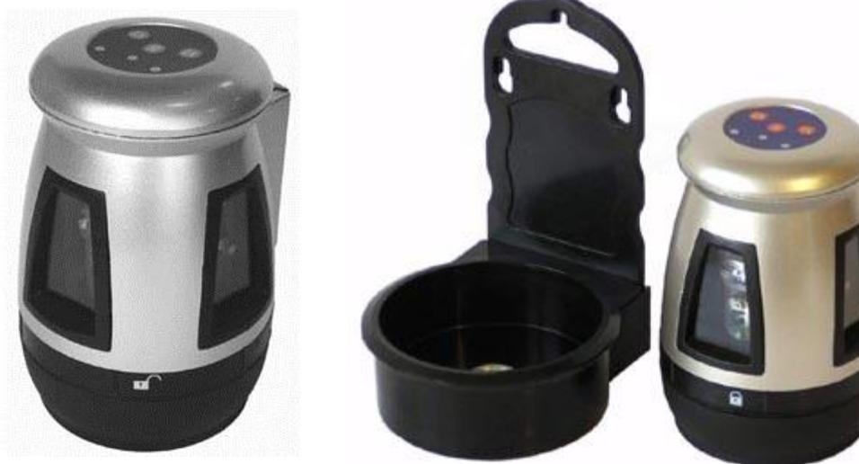
Прибор **SL803** обеспечивает построение одной горизонтальной плоскости и двух вертикальных плоскостей, которые расходятся под углом 90° друг к другу. Одна из вертикальных плоскостей пересекается с горизонтальной, тем самым создавая проекцию креста на стене.
